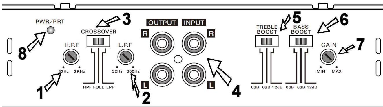
1. **H.P.F High pass Filter**- Регулиране на високите честоти при режим на възпроизвеждане на високи честоти.
